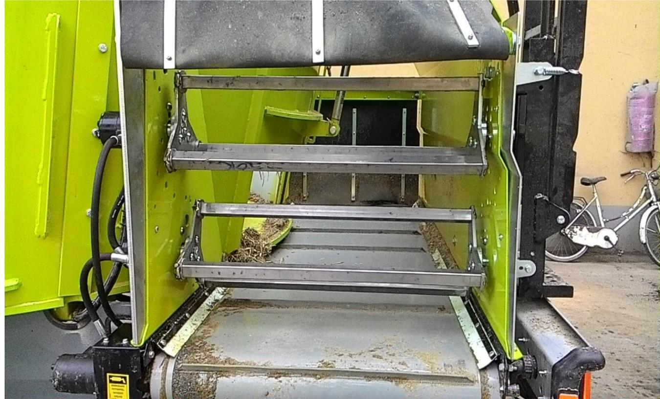
**Struttura del sistema a due aspi**
