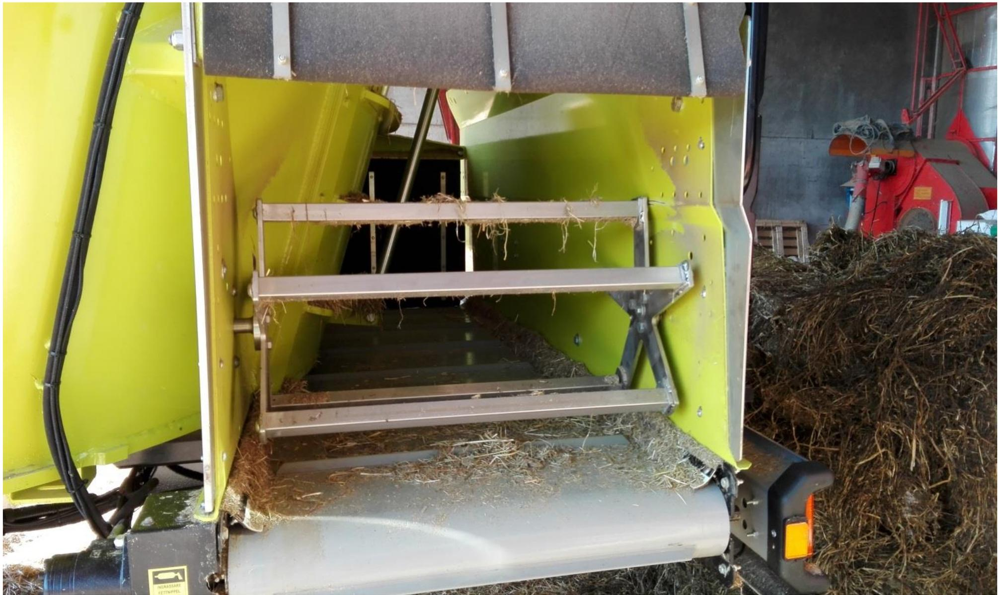
**Struttura del sistema ad un aspo
